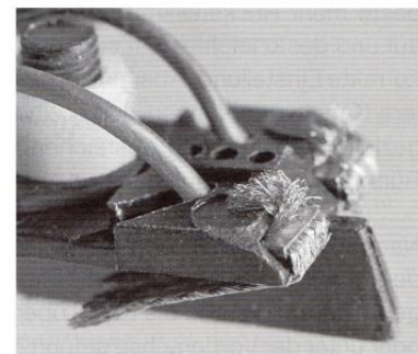
Kabel stecken von hinten im Leitkiel und sind vorne umgebördelt. Der Schleifer wird unterhalb eingesteckt und sitzt so sehr fest.
