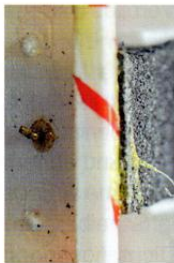
Der Halter entstand aus „Body-mount“-Schaumgummi von Fischer. Durch Offenporigkeit ist er leicht und damit gut für die Abmessungen des Porsche 962 geeignet.
