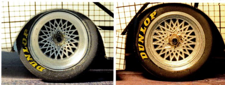
Eine gerundete Reifenflanke in Großaufnahme. Sie hat Liebhabercharakter, denn in Praxis kostet sie Auflagefläche. Beim Vorderrad ist sie sogar schwierig zu realisieren, da die eigentliche Kante aus Gründen der Performance keine Rundung aufweisen soll.
