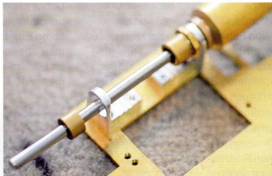
Das sogenannte DagTool hier im Einsatz, um die Achshalter exakt auszurichten. Hier bestehen sie aus gefrästem Aluminium. Sie sollen genau fluchten. Später sollen die Lager spannungslos und gerade in den Haltern sitzen.
