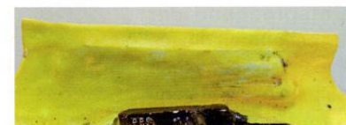
Gesäuberte Oberfläche nach dem Entfernen von Kleberrückständen aus der Karosserie, notwendig für eine gute neue Verklebung
