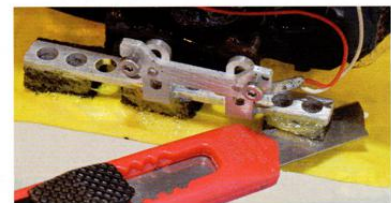
Heraustrennen eines schlecht eingeklebten Halters mit dem Messer
