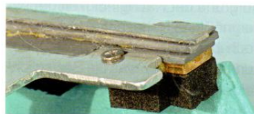
Um eine Karosserie auf das Mindestgewicht zu bringen, sollte möglichst viel Ballast in den Schweller wandern, ohne an der Karosserie oder dem Chassis zu reiben. Die Montage am Halter ist oft am einfachsten.
