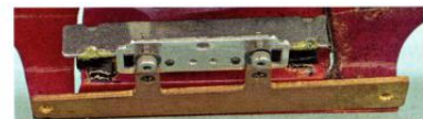
Durch Unterlegscheiben zwischen dem Karosseriehalter und -träger wurde hier die Karosserie höher gesetzt, damit auch die Gewichte. Das hebt allerdings den Schwerpunkt unnötig weit. Um auf das richtige Karosseriegewicht zu kommen, wurden hier Messingstreifen am Halter verschraubt.
