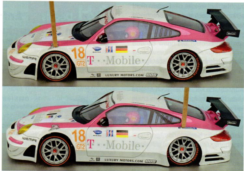
Eine Prüfung der Freigängigkeit der Räder in den Radkästen. Zur Untersuchung der Flexibilität der Karosserie sollte man das Auto aber in die Hand nehmen und von unten auf die Ecken der Halter drücken, um die Federung und den „Wackel“ im Chassis nicht berücksichtigen zu müssen.
