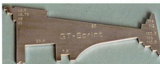
Mittels der aus Aluminium gefrästen GT-Sprint Lehre lassen sich Spur, Mindestdurchmesser und -breite der Vorderräder sowie die karosserie-spezifischen Komponenten wie die Heckspoilerhöhe und der Radstand leicht kontrollieren, ferner für die meisten Fahrzeuge auch die Höhe der Seitenschweller über Grund.
